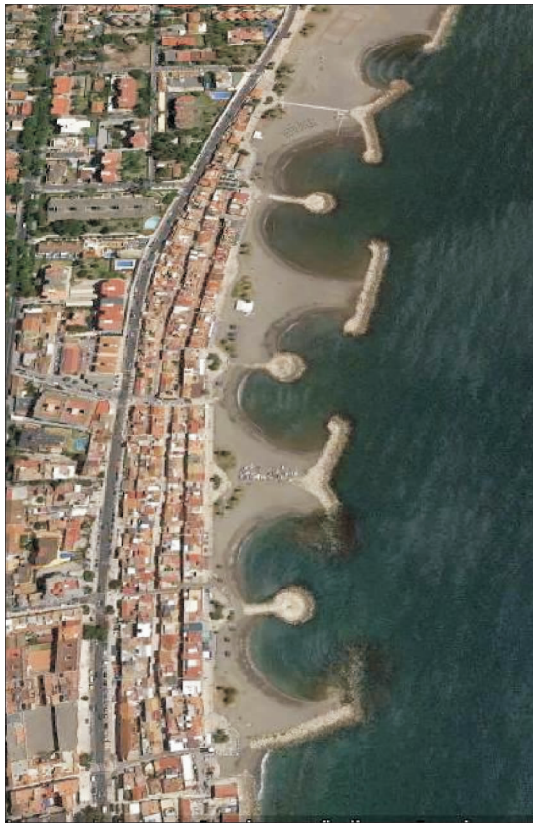
图6 西班牙 Pedregalejo 海滩鱼尾状丁坝群 (底图:谷歌地球,编辑)
